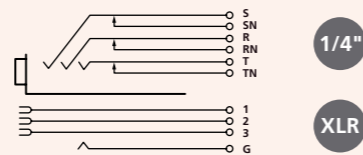
Wiring: Example of NCJ9FI-H
